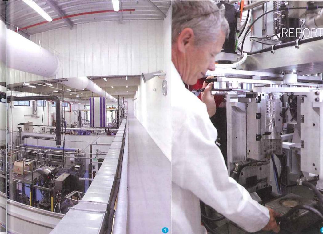
1. La ligne pilote du DRPC comprend une dizaine d'équipements permettant de couvrir l'ensemble du process, de la fabrication de la bouteille au transport sur palette en passant par l'injection de la préforme, l'étirage-soufflage, le remplissage-bouchage, le convoyage.
